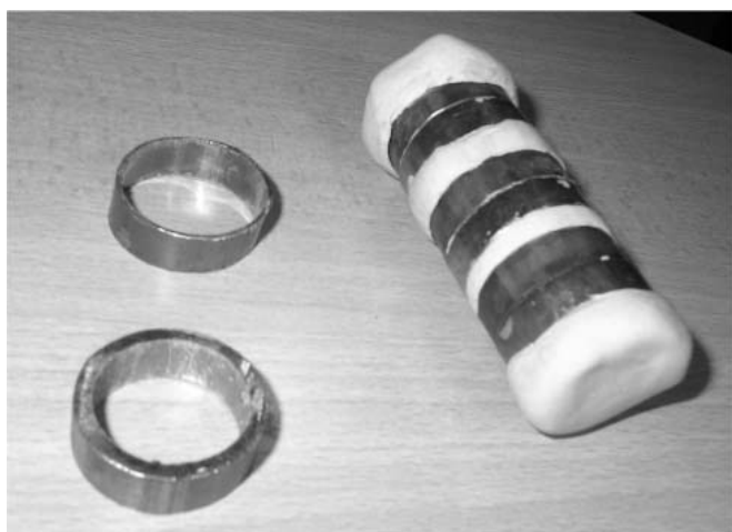
6. ábra. Három-három vas- és rézcsődarabból kialakított cella.
